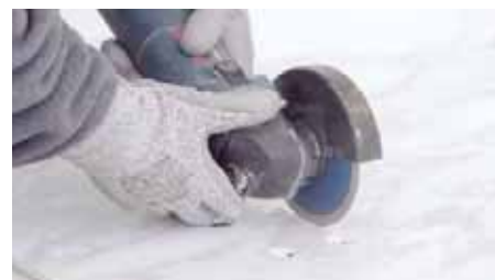
Smerigliatrice angolare con disco diamantato / Winkelschleifmaschine mit Diamantscheibe
